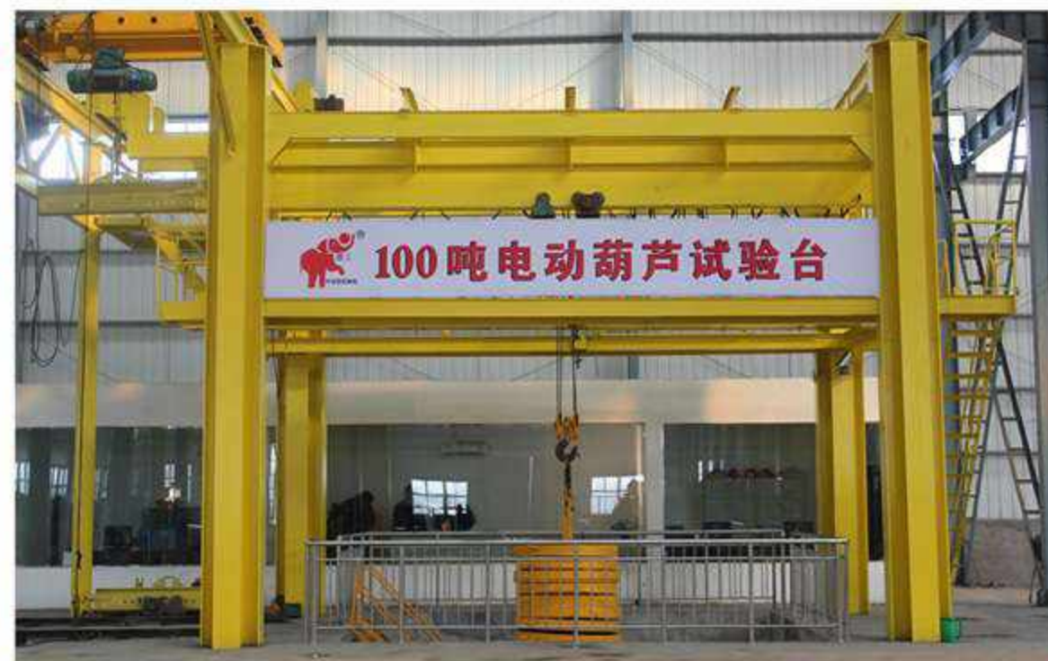
电动葫芦试验台 electric hoist test stand
