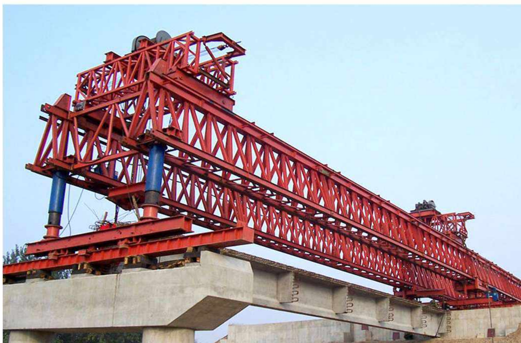
出口到阿尔及利亚的架桥机 bridge erection crane exported to Algeria
