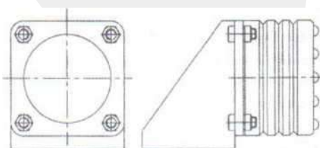
图 6 聚氨酯缓冲器 Polyurethane buffer
